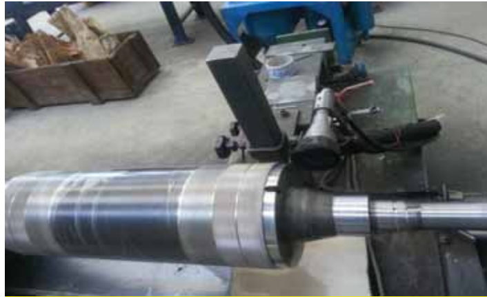
Fig. 15. Sabbiatura di un cilindro goffratore
