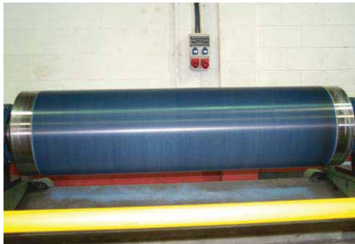
Fig. 26: contropressa in cartalana tornita
