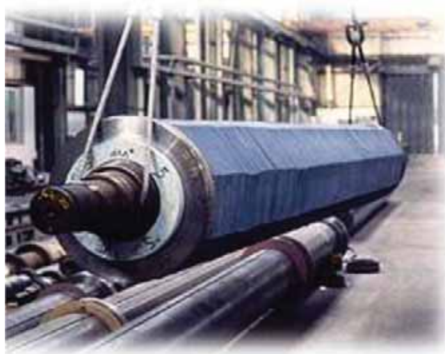
Fig. 25: cilindro in cartalana prima della tornitura
