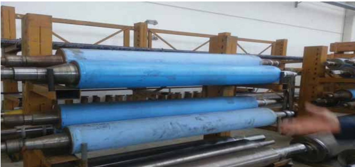
Fig. 16: Cilindri d'acciaio rivestiti da calza siliconica da rettificare
