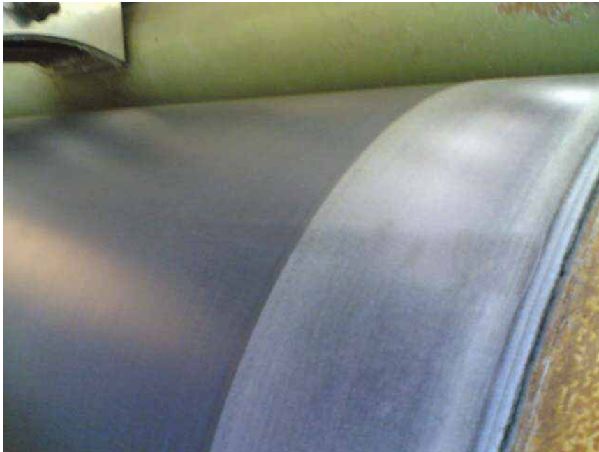
Fig. 39: Effetto dell'usura della cimosa sulla contropressa di cartalana
