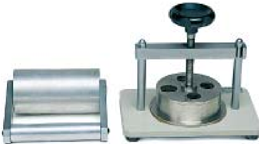
Attrezzature per la determinazione dell'assorbenza COBB
