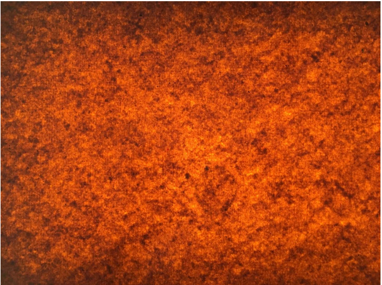
Immagine della carta analizzata in trasparenza. Si nota la presenza di agglomerati fibrosi più scuri che indicano una non perfetta distribuzione delle fibre (formazione del foglio)
