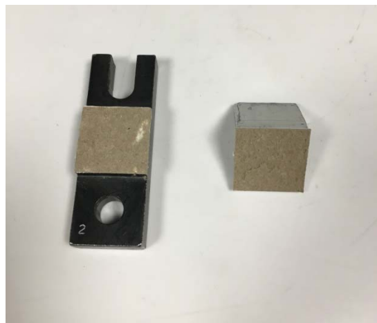
Strumento per il controllo della resistenza alla delaminazione e campione delaminato dopo la prova
