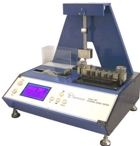
Strumento per il controllo della resistenza alla delaminazione e campione delaminato dopo la prova
