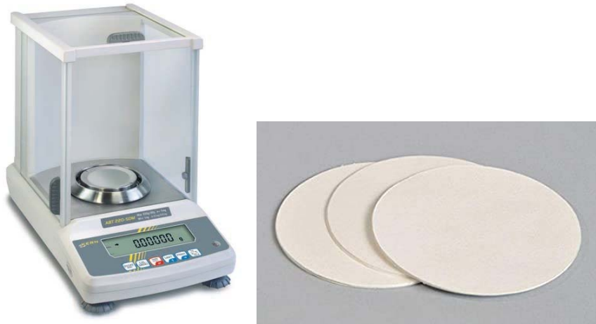
Bilancia e campioni per l'analisi di grammatura
