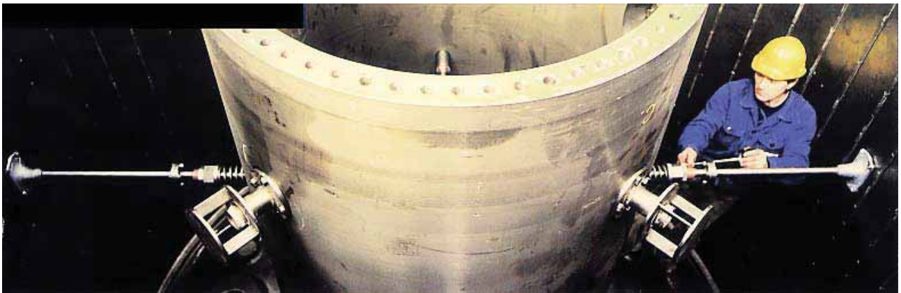
Fig. 6 – Foto dell'interno di un cilindro monolucido
