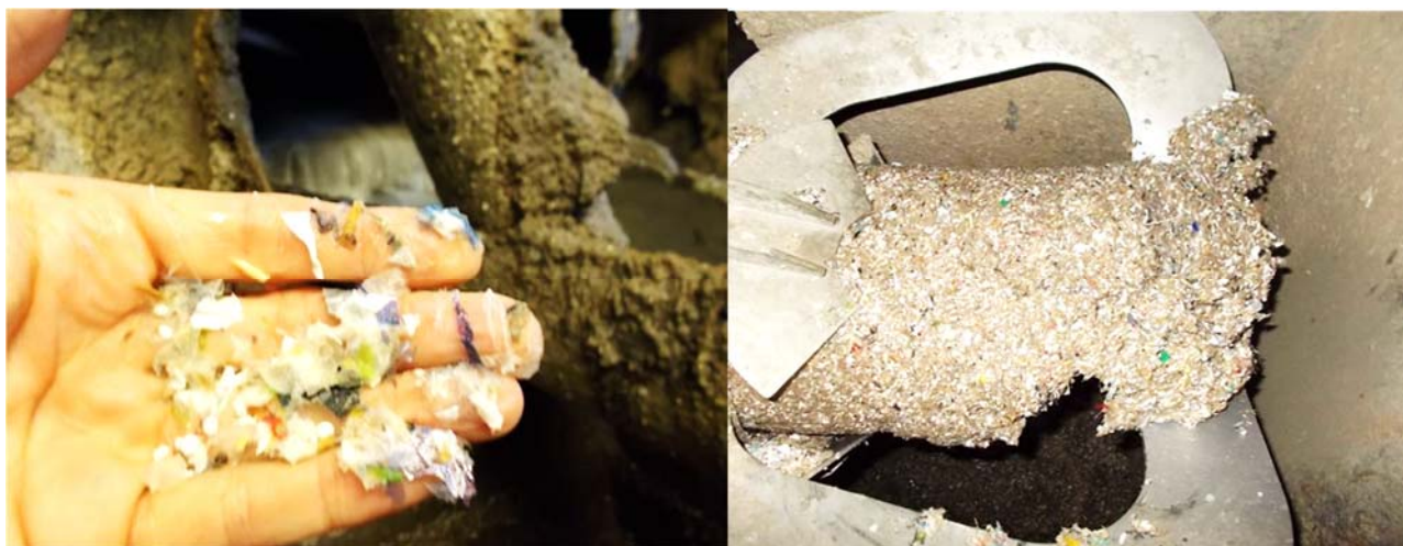
FOTO 7: CONTAMINANTI SCARTATI DAI VARI IMPIANTI EPURATORI
