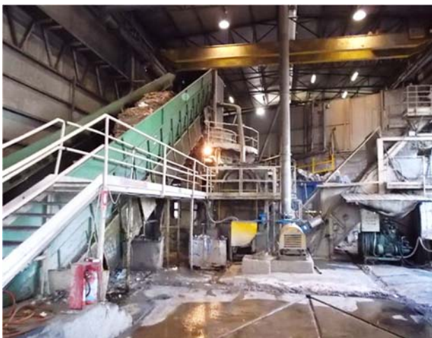
FOTO 4: FOTO D'INSIEME CON NASTRO TRASPORTATORE, PULPER E PULPER SCREEN
