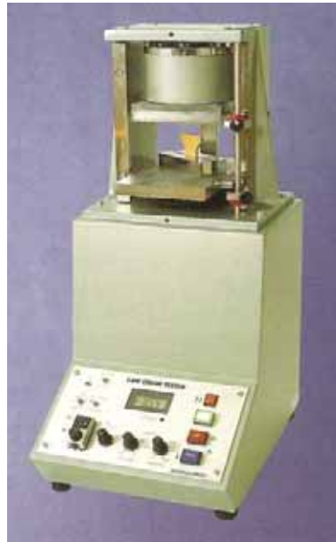
Presse da laboratorio per tutti i test di compressione RCT- CMT- CCT- ECT-FCT
