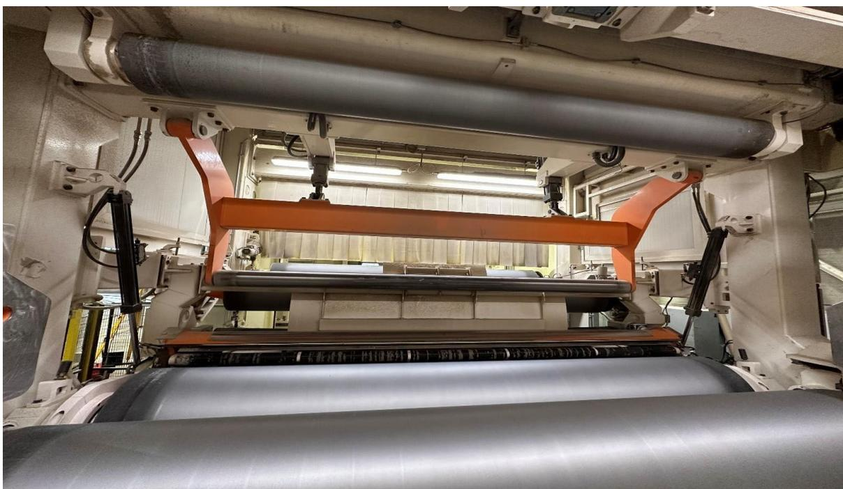
*Rulli portanti denominati (master e slave) dove viene avvolta la voltata, più rullo superiore (cavaliere), battola per gruppo taglio ed espulsore per scaricarla sulla culla.*
