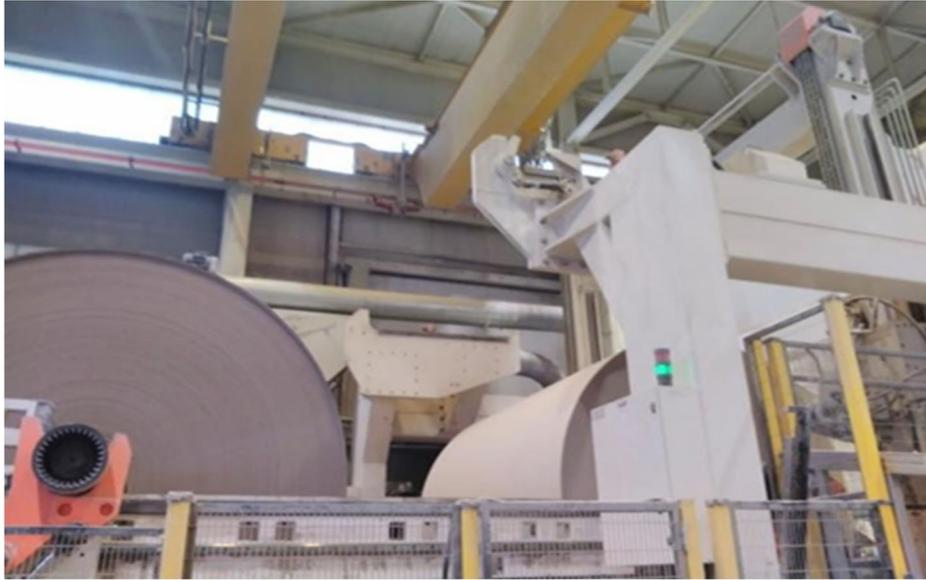
*Trasporto rotolo automatizzato tramite selettore e dotato di due Pinze che fanno da ascensore per scaricare i pali presso il loro deposito di parcheggio (massimo 3)*
