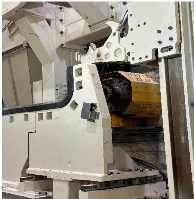
*Campana che si inserisce in automatico grazie ad un sensore che legge il rotolo e pinza lato comando che permette di portare su il palo vuoto a fine ribobinatura*
