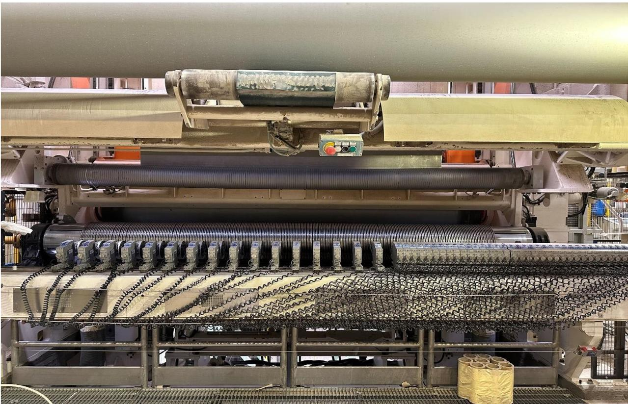
*Sistema di taglio automatico controllato da due traslatori superiore (controcoltelli) ed inferiore (coltelli) gestito da un sistema computerizzato chiamato DIENES sistemando i tagli in base alla ricetta che gli viene inviata*
