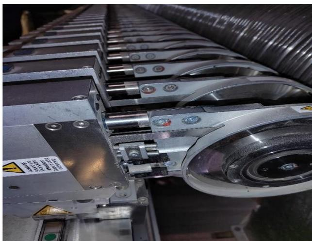
*Coltello dienes con lama diametro 135 supportato da un sensore di regolazione coltello*
