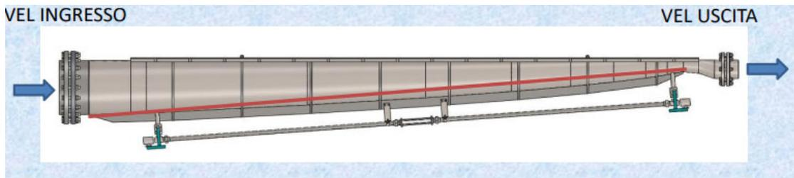
Fig. 6 (collettore conico cassa di afflusso)
