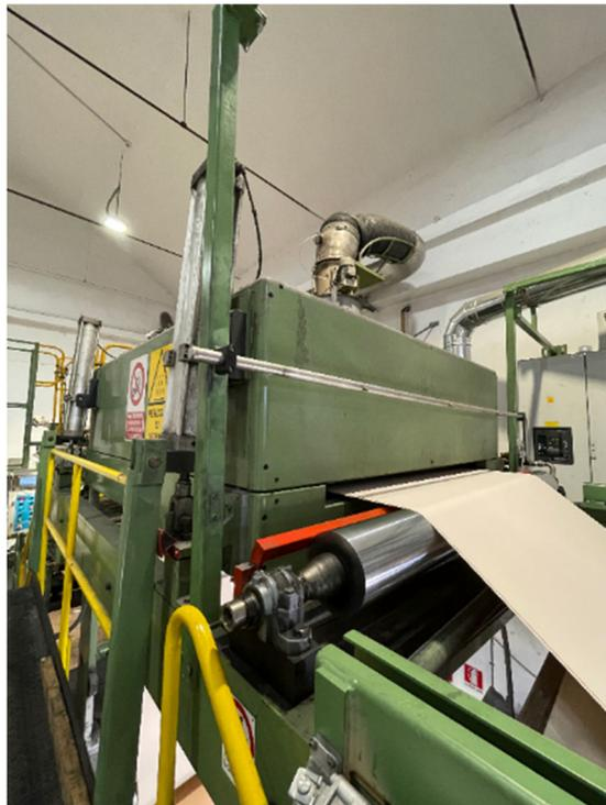
Il forno a gas è sempre alimentato ed è necessario per il funzionamento della macchina, raggiunge una temperatura massima di 150 °C che manteniamo costantemente per avere una buona produzione.
