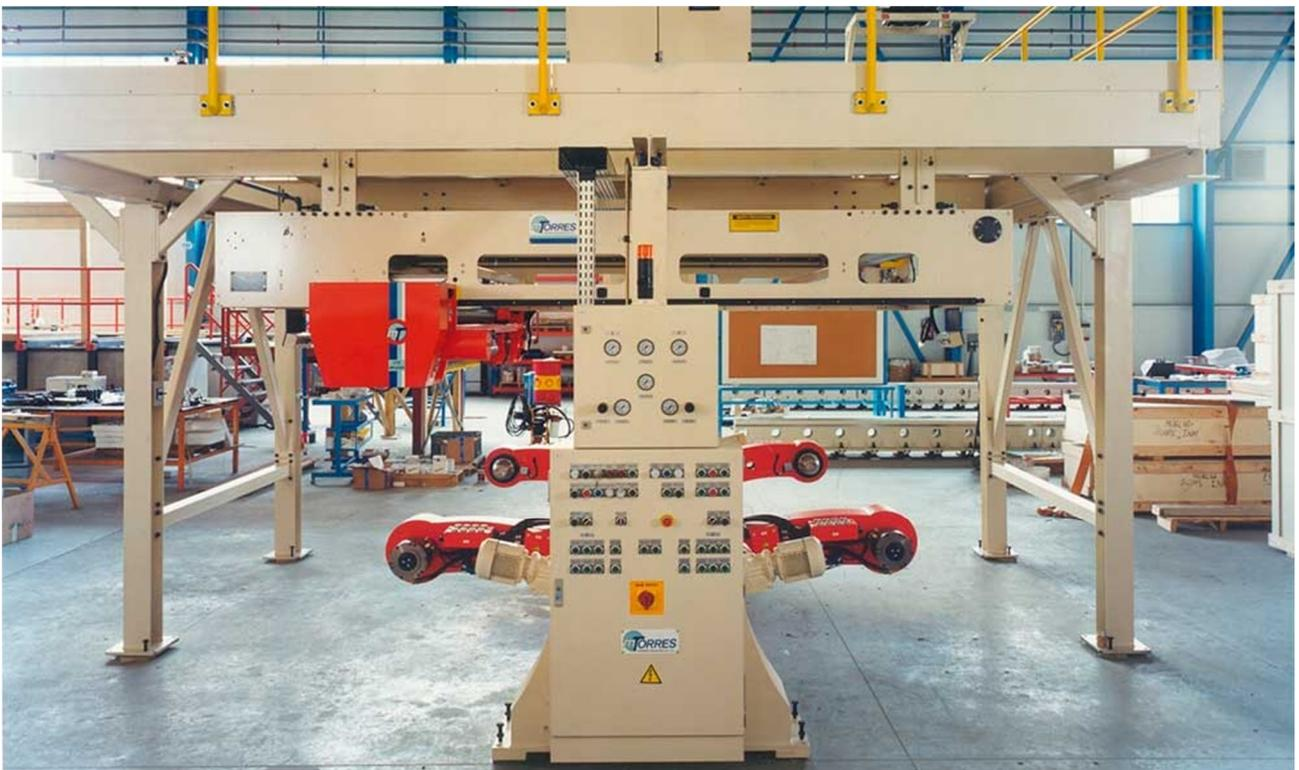
*Figura 4.3 – Una unità di splicer per la giunta automatica.*
