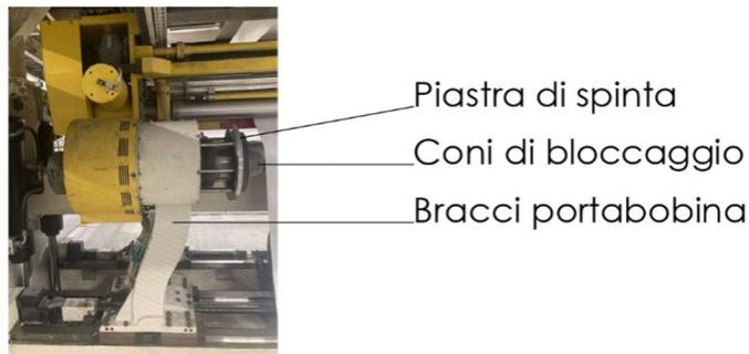
*Figura 4.2 – Braccio portabobina con sistema di scaricamento anime pneumatico.*
