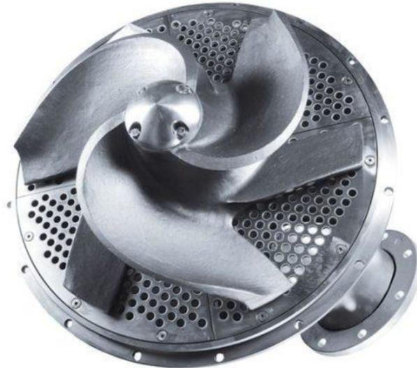
*Figura 6: esempio di girante del pulper a bassa densità*
