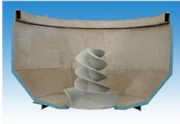
*Figura 7: esempio di pulper a media densità*
