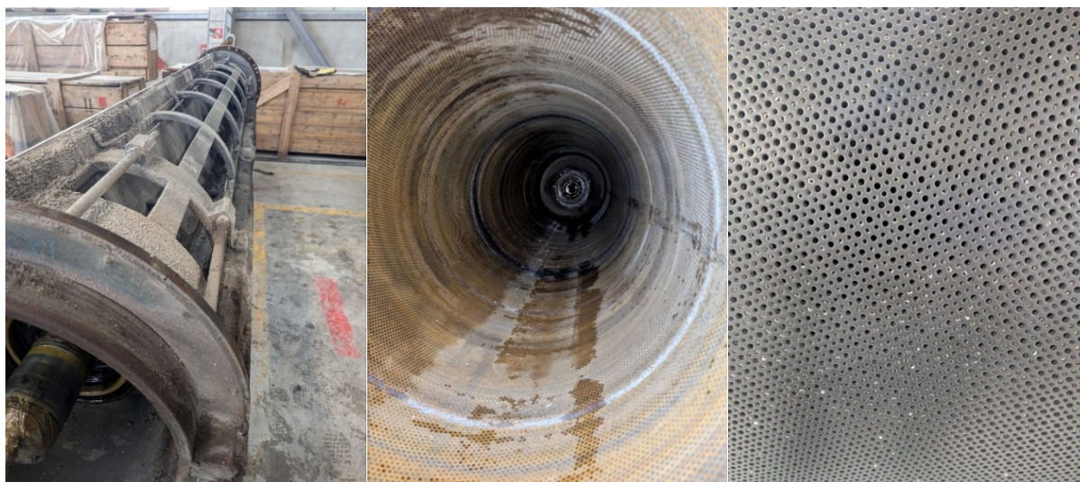
Prima pressa del monolucido smontata, per valutare l'usura e lo sporco
