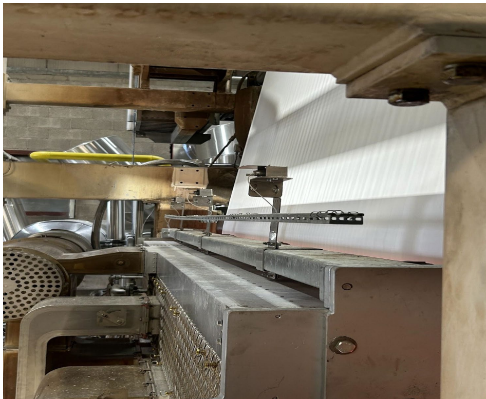
Immagine 5: pirometri posti alla fine della cappa
