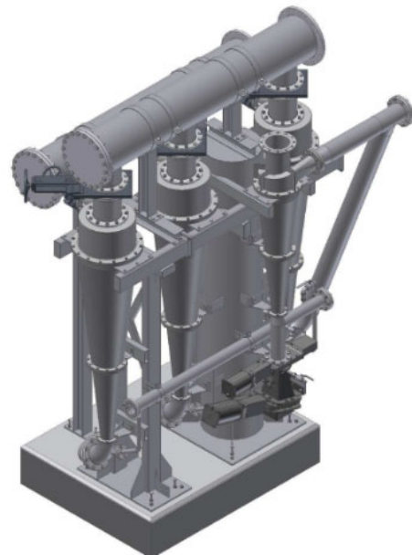
Impianto DPD con 3 cleaner a scarto continuo e un secondo stadio temporizzato
