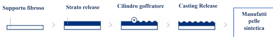
Figura 5.1 – Diagramma di flusso delle carte soggette al processo di extrusion coating e goffatura
