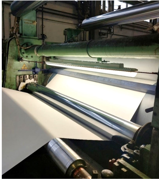
Figura 4.4 – Passaggio carta tra cilindro inciso e contropartita, di una macchina goffratrice
