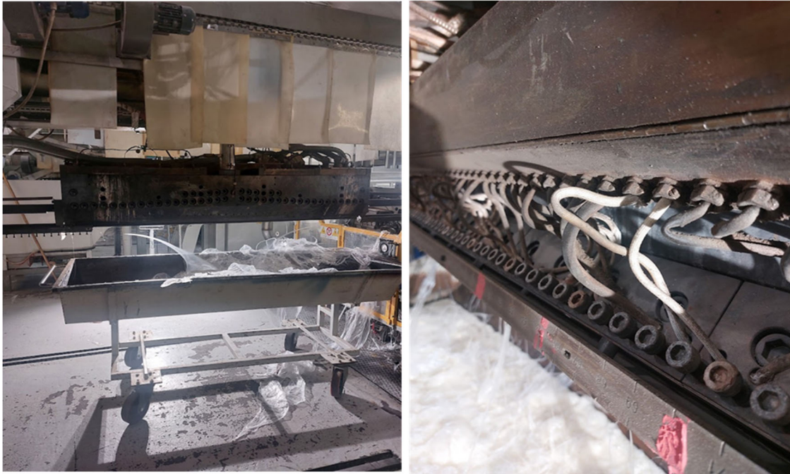
Figura 3.4 – a sinistra testa di estrusione; a destra dettaglio dei tasselli termici regolabili in prossimità del labbro della testa di estrusione
