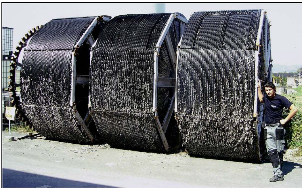
Fig. 4.7 Pannelli plastici, montati prima di essere immersi nell'apposita vasca
