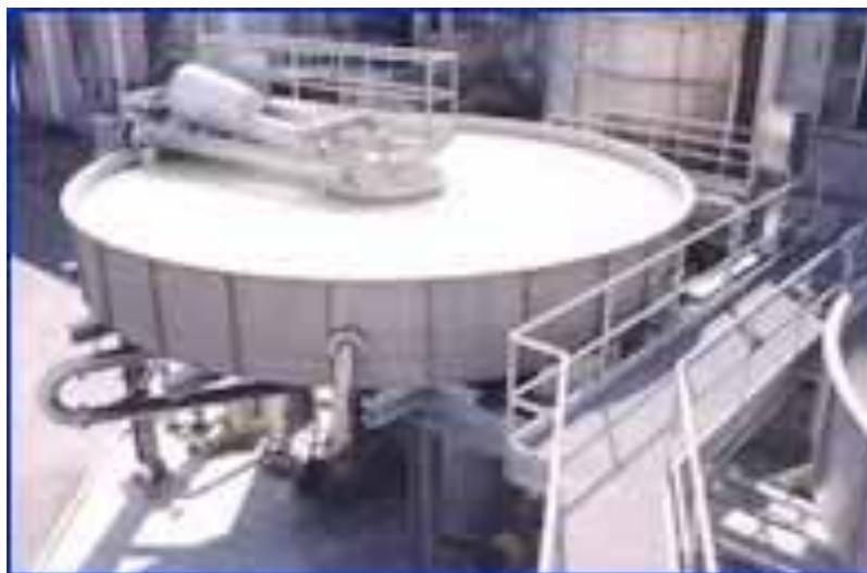
L'impianto è caratterizzato da una cella di flottazione circolare, in acciaio inossidabile. Il flusso del fluido entrante si distribuisce dal centro verso la periferia della vasca secondo una dinamica particolare, in modo da ottimizzare la separazione delle particelle solide dal liquido con tempi di processo molto ridotte.
