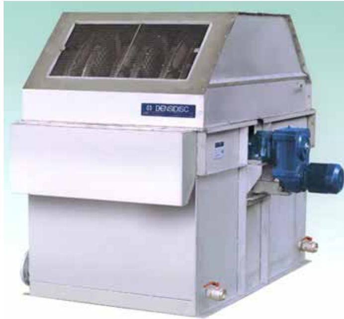
La miscela liquido-solido da trattare è immessa, attraverso la camera di alimentazione, alla zona principale equipaggiata con coppie di dischi sulle quali sono montate tele filtranti metalliche. La differenza che si viene a creare tra la camera di alimentazione e quella del filtrato, fornisce la sufficiente differenza di pressione affinché la separazione acqua-solidi attraverso le tele possa avvenire.
