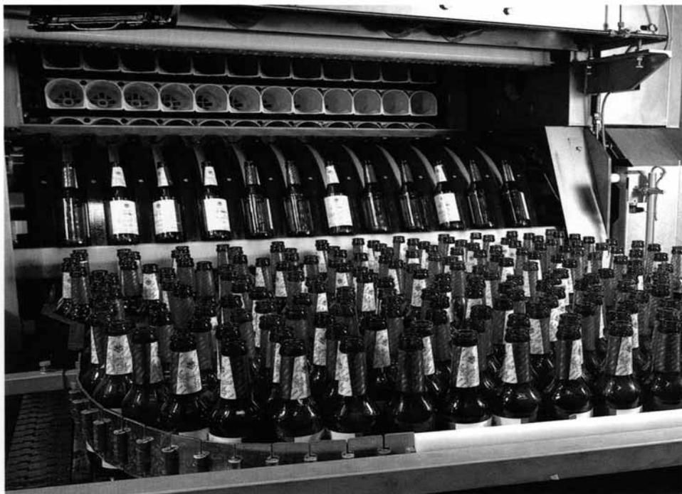
Fig. 2.1 Immagine d'ingresso delle bottiglie di birra in una macchina per il lavaggio.
