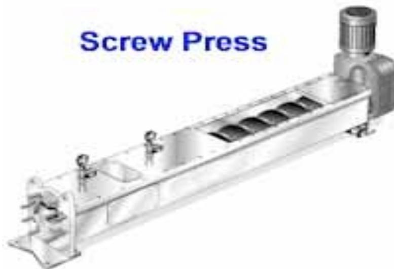
La pressa a vite è caratterizzata da un lento movimento meccanico di una coclea, la spremitura è continua ed è facilitata dal drenaggio per gravità all'ingresso inferiore della vite e successivamente, riduzione del volume del materiale spremuto dall'ingresso all'uscita della macchina.
