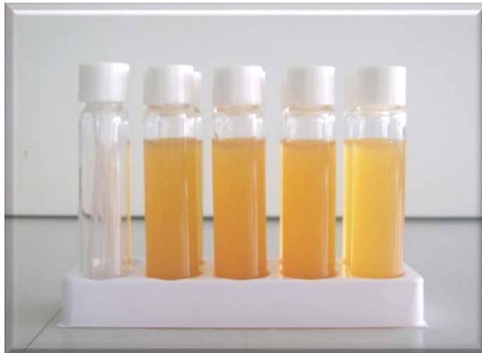
Figura 10: Kit per il controllo di SRB e Clostridium
