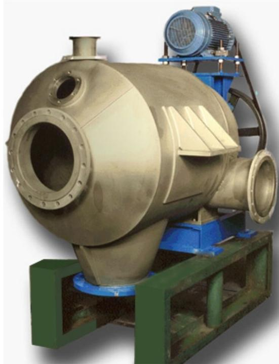
Una volta spappolato il materiale fibroso, si passa alla prima fase di pulizia. Il Pulper-Screen costituisce un sistema di separazione e scarico delle impurità trattenute all'interno di un pulper. L'operazione di separazione è ottenuta durante la fase di estrazione dell'impasto dallo spappolatore.
