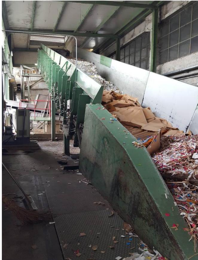
Il pulper in questione è un pulper a batch di circa 30 metri cubi che in base al tipo di ricetta può ospitare ricette che vanno dai 55 ai 45 quintali per un tempo di circa 15/30 minuti ad una densità del 18/19%, gestione di carico, scarico e spappolamento sono gestite in automatico per garantire una corretta preparazione ed un uniformità dei vari carichi nell'arco dei cicli produttivi ed evitare quindi degli scompensi poi in macchina continua.
