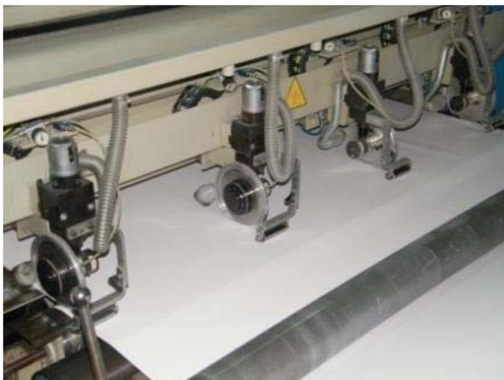
giunte tra rotoli nel momento del cambio “carica”. La velocità massima sul formato sincrono (per tale macchina è di 880 mm) è pari a 450 m/min e la
