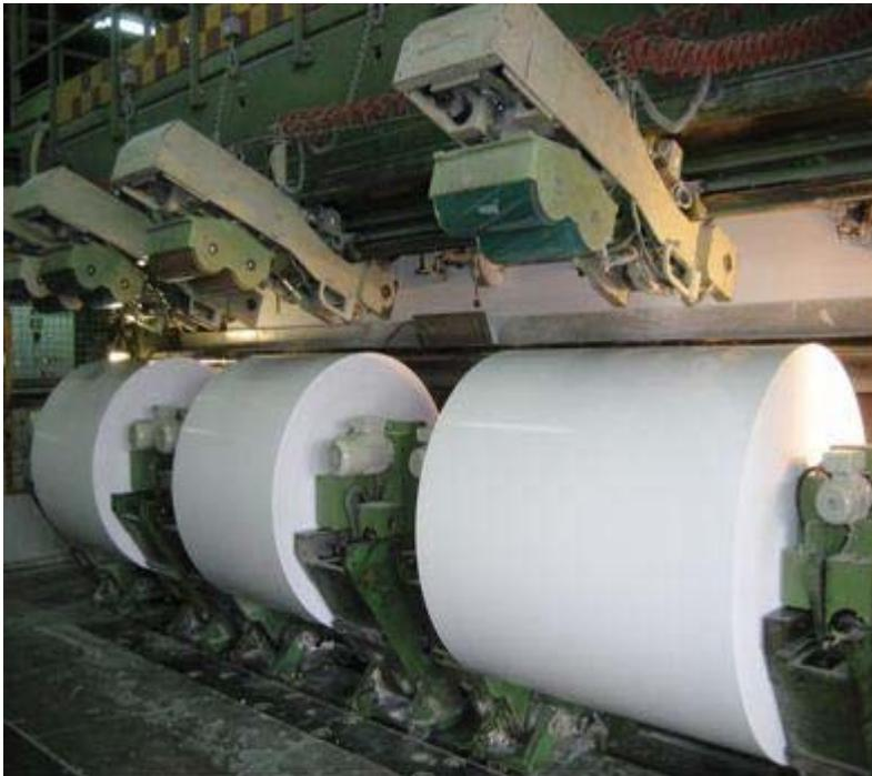
A differenza delle altre bobinatrici dello stabilimento, ha una struttura fornita da un solo cilindro, con 6 pressine, quindi a *taglio separato*.
