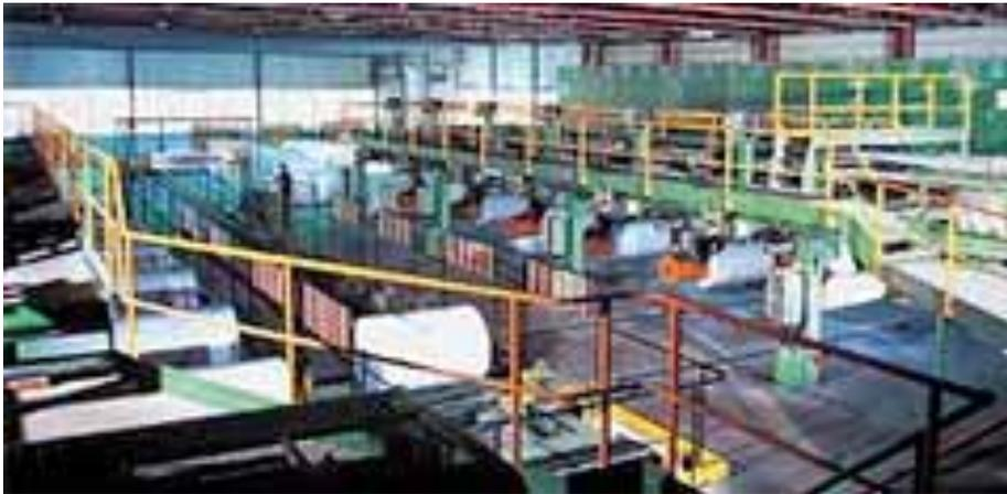
prestabilita (per esempio 75%) e che permette un’andatura più lenta e sicura dei nastri in uscita. Anche cilindri di diversi diametri e pesi, applicabili a seconda dei tipi di carta mantengono il perfetto allineamento dei fogli che stanno per essere depositati sopra la “paletta”, la quale si abbassa progressivamente sopra il cosiddetto “tavolo della pila”.
