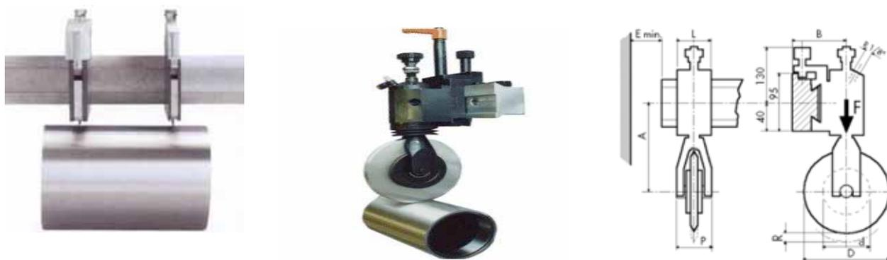
**3) Taglio a lametta.** Si impiega un coltello circolare sottile, rotante a velocità elevate ed avente un tagliente assai affilato, che penetra in un nastro di carta condotto su due rulli di rinvio o su bussole scanalate. Rispetto ai coltelli a tazza in lamiera di acciaio, autotemperate,
