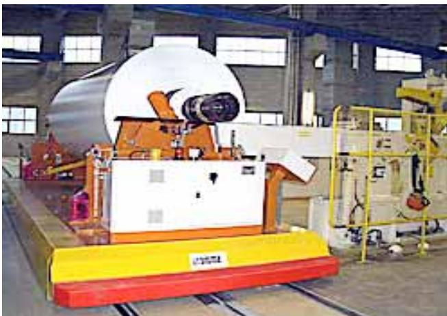
Concludendo il paragrafo vanno segnalati fra i dispositivi automatici di movimentazione gli “espulsori”, cilindri metallici fissati fra due bracci che spingono la bobina facendola rotolare.
