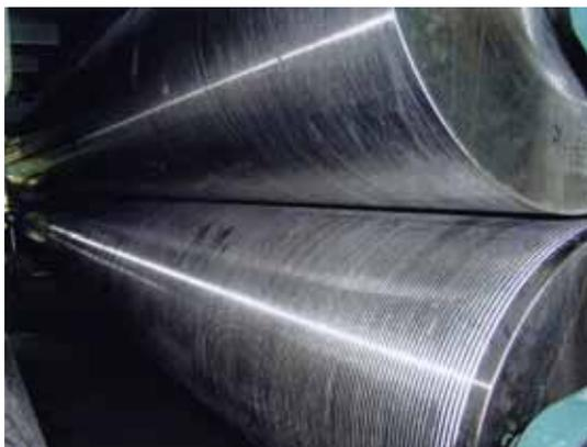
Con cilindri di piccolo diametro abbiamo pressioni maggiori per tempi di contatto molto bassi, viceversa con cilindri pressori di grande diametro avremo aree di contatto maggiori per cui un tempo di contatto alto con impulsi di pressione ridotti. Per evitare fastidiosi attaccamenti del foglio di pasta sulla tela superiore della pressa gli ultimi due cilindri pressori sono a giri variabili in modo da garantire il dovuto slittamento del foglio di pasta.
