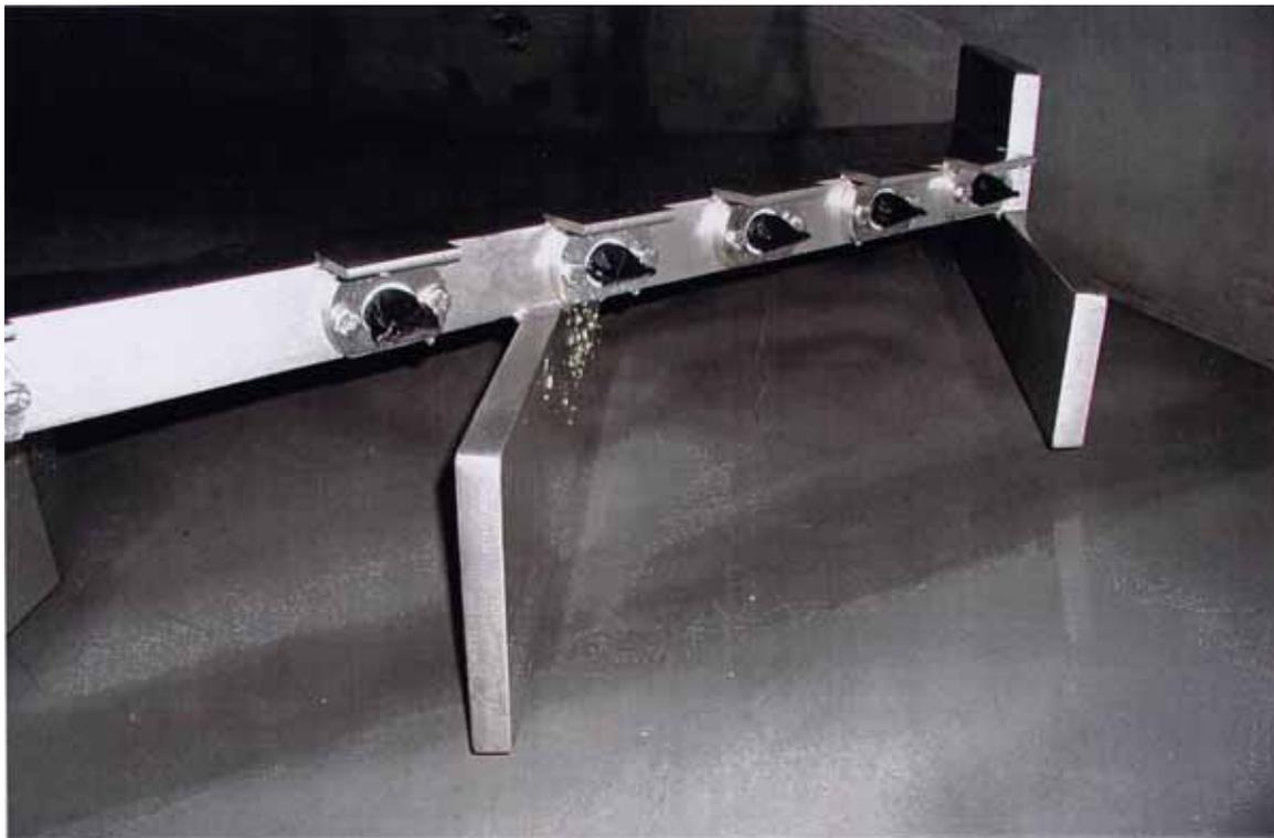
L'acqua per la diluizione viene portata al braccio raschiatore attraverso il tubo di mandata con guarnizione a labbro integrata.
