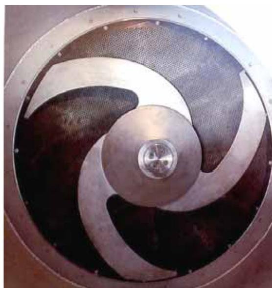
Figura 15: particolare della girante dell’epurex.
