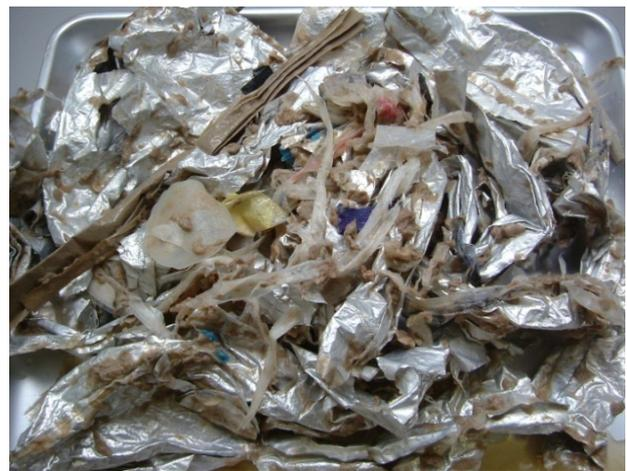
visibili gli stessi contaminanti dopo il lavaggio del trommel, come si può vedere una buona parte delle fibre che ricopriva gli scarti è stata rimossa e quindi recuperata con l'acqua di lavaggio.
