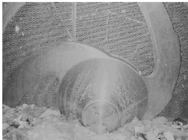
L'epurex ha un sistema di scarico temporizzato, quando il cestello è pieno di contaminanti un ciclo di lavaggio provvede alla loro pulizia prima che lo sporco venga espulso dal basso, pressato attraverso una coclea a vite per essere disidratato.
