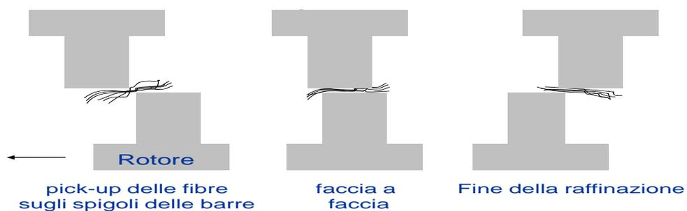
Le lame del rotore si muovono a distanza molto ravvicinata rispetto a quelle dello statore, ma non a contatto.
