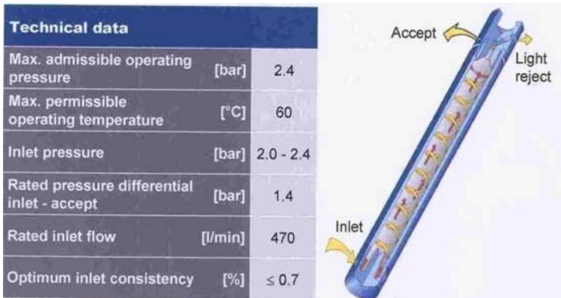
Fig. 13 - Light Weight Cleaning (Coreclean- Voith).
