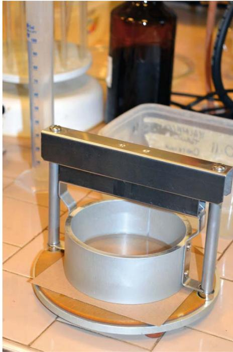
**Flat Crush Test (FCT):** misura la resistenza alla compressione in piano del cartone ondulato. Non si applica al cartone ondulato a 2 onde. Come per lo scoppio la misurazione si esprime in kPa (kilo Pascal).
