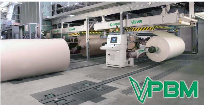
La giuntatrice, inserita sopra una coppia di portabobine, ha la funzione di cambiare rotolo di carta senza interrompere il ciclo produttivo tramite il congiungimento automatico del lembo della nuova bobina a quella in uso.
